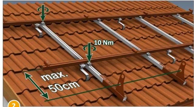
2 Fissare il supporto fermaneve con una coppia di serraggio di 10 Nm.
