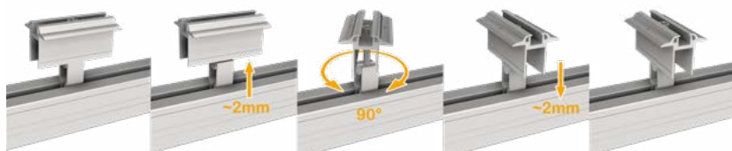
Serraggio verticale e orizzontale mediante semplice sollevamento e rotazione della graffa
