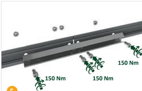
5. Posizionare i connettori sul lato senza cavi dell'arcareccio e avvitarli con i mezzi di collegamento forniti (vedere figura 5)
