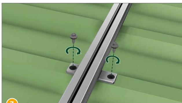
**7** ... fissare il Trapez 6 con due viti autofilettanti 6 x 25 (Cod. art. 93160-25) per lato, applicando la coppia di serraggio corretta, procedendo dal Trapez 4-2.0 verso l'esterno.
