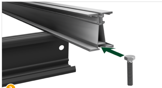
2 Inserire la vite della morsetto per trave in acciaio (Cod. art. 41502-00) nel canale inferiore del puntone e spingerla fino a battuta sul supporto del puntone.
