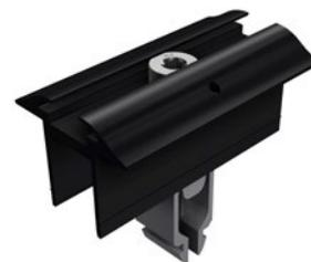
**Morsetti intermedi** con perno di messa a terra per telai di 28 mm - 45 mm altezza
